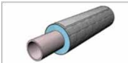
Obložiti cijev i zatvoriti izolaciju ljepljivom trakom
